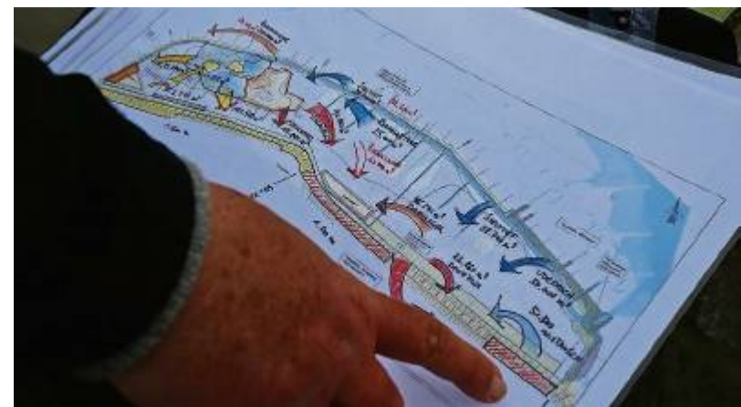
Diese Karte aus der Bauzeit dokumentiert, wie viel Boden für den Umbau bewegt werden musste, damit das Wasser in alle Bereiche des Grodens fließen kann. Foto: Böning
